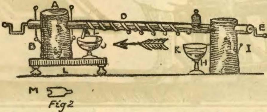
impedem-lhe a saída dos suportes, dois *H*, *I*, fixam a rôlha que está na prancheta e os dois últimos seguram a segunda rôlha.
