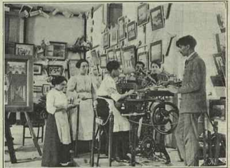
A MAQUINA DE FABRICAR SUBSCRITOS COMPLETOS DE QUE É AUTOR O SR. CLAUDINO INACIO DA COSTA, DA IMPRENSA NACIONAL
