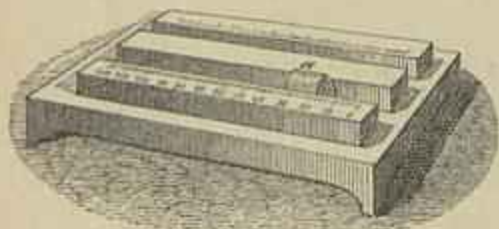
Fig. 44 — Pyrometro de Wedgwood
