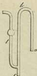
Fig. 30 — Modelo de syphão para liquidos corrosivos.
