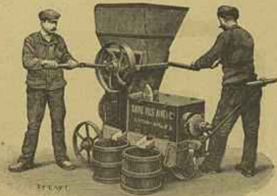
Prensa esmagador-duplo de Satre
