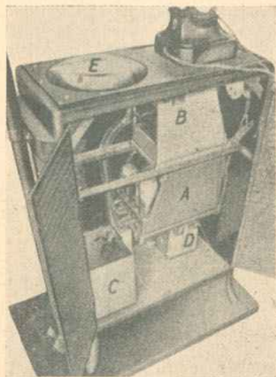
Aspecto do receptor. O foco de luz é concentrado pelas lentes B e F sobre a célula foto-eléctrica que se encontra no interior da caixa C. Os sinais luminosos passam em seguida ao amplificador A B e D
