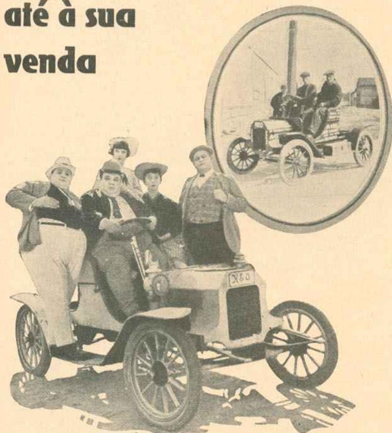
OS PRIMEIROS AUTOMÓVEIS. Fortes e feios. Motor de 2 cilindros. Lubrificação por chapinhagem. Inflação de marteos. *Mise en marche* por manivela ao lado do estribo
