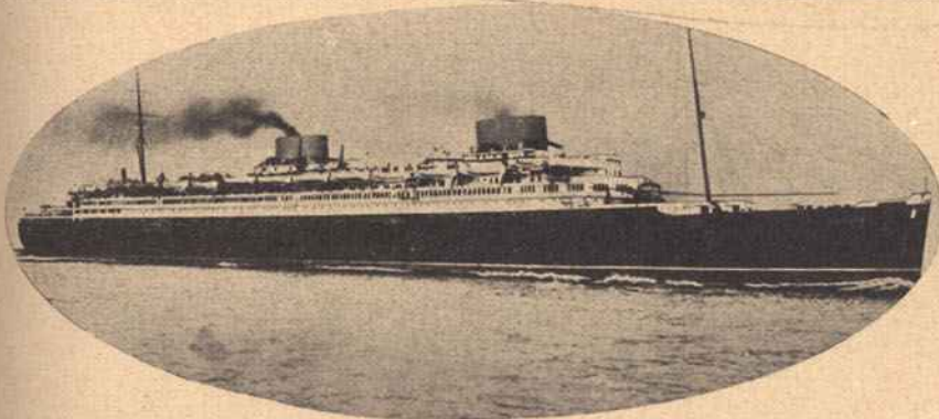
NO OVAL, À ESQUERDA: — O grande transatlântico Europa de 31.000 toneladas, com 235 metros de comprimento 31 metros de altura e 27 metros de largo, para 2.200 passageiros e 1.000 homens de tripulação, movido a hélices Gargavil e que acaba de bater o record da velocidade em travessia do Atlântico. (Foto Orrtos.)
