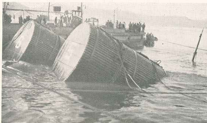
O rebocador «Cabo Sardão», que se encontrava há mais de três meses no fundo do Tejo, foi posto a flutuar. As gravuras acima mostram: os dois primeiros flutuadores que vicram à superfície com a ré, e, à direita, o rebocador emergindo.
