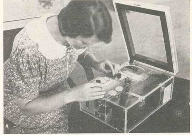
O novo «Cofre Olímpia» em que estão montados uma antena de quadro e um alto falante dinâmico exibido na Exposição de Rádio em Berlim.
