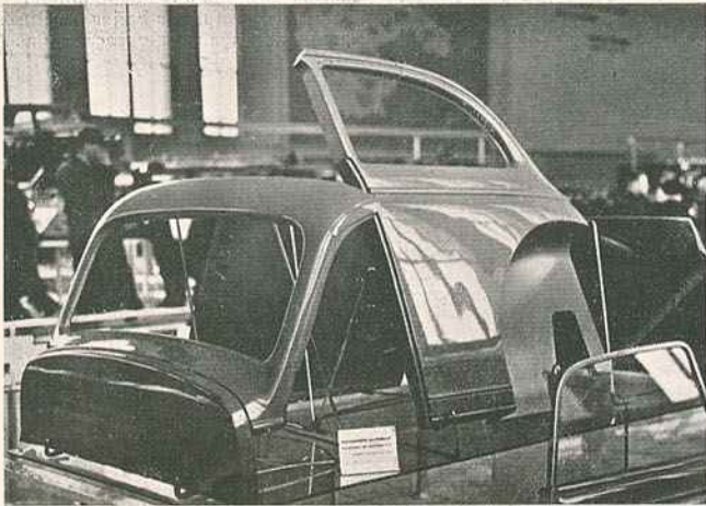
Automóveis construídos em fibra sintética que apresenta maior capacidade de resistência que o aço
