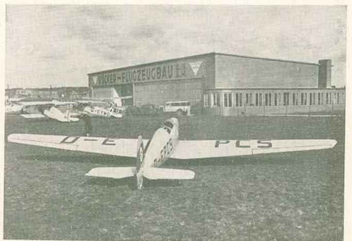
A nova avioneta «Student» que, com um motor de 50/60 H. P., gasta apenas 7 litros de combustível aos 100 quilômetros, atingindo uma velocidade de 175 à hora
