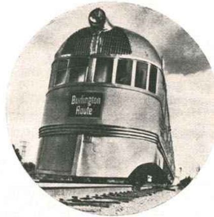
Uma das automotoras mais rápidas da América do Norte. É accionada por um motor Diesel e coberta por uma carapaça de aço inoxidável.
